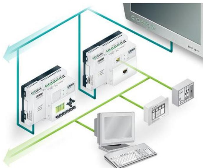
La mise en œuvre des micro-automates programmables **nanoLine** est d'une extrême simplicité. Leur langage de programmation graphique sous forme de **diagrammes de fonctionnement** élaborés à l'aide de six instructions seulement ou de **langage à contact** (LADDER), proposés par le logiciel **nanoNavigator**, sont très intuitif.
